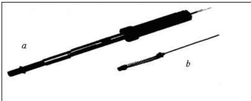
*a : Cylindre, b : aiguille contenant la fibre*
